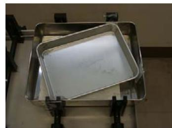
(図2)。揺動テーブルを5分間揺動(矢印方向)させると、比重の重いアルミニウム粒子が優先的に右方向に移動し、アルミニウム粒子(灰色)とプラスチック類(黒色)を分離することができます(図3)。また、この装置を用いて、廃自動車のシュレッダダスト(サイズ3mm以下)から銅線を効率よく回収できます。
