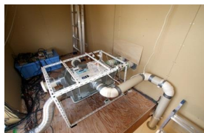
図1 熱交換換気システムの効率実験
