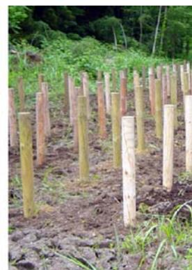
防腐木杭の腐朽試験
