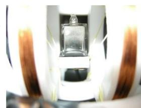
図2 カリウム蒸気セル
