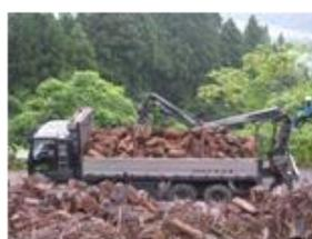
土場残材の積み込み試験
