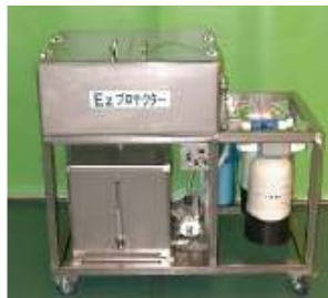
金型防食保管庫
