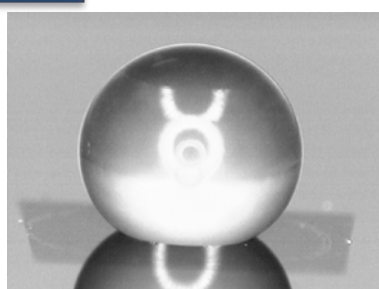
微細な周期構造により現れた超撥水性
