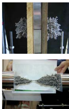
微小鉄球を吸着したバルク磁石
