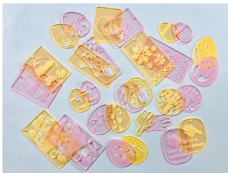
写真 8：アクリル板を切り出した学生作品の結果（レーザー加工機使用）
