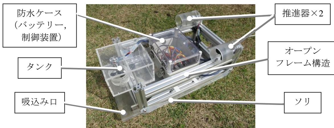
図 1 緩速ろ過池清掃ロボットの外観
