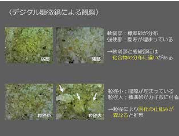
カキ殻を利用した土の固化処理の実験結果
