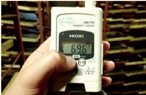
写真の温湿度計測記録機 9 台を用いて温湿度の推移を調査した
