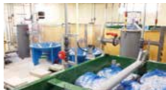
三陸水産研究センターの閉鎖循環型陸上養殖システム
