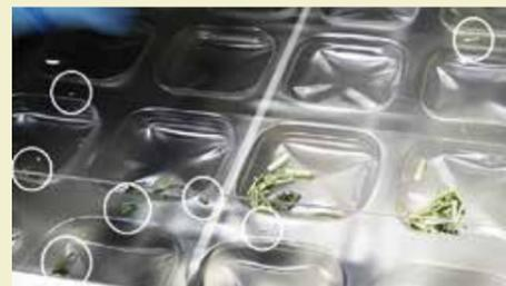
静電気で拡散した具材 (○囲みのもの)
