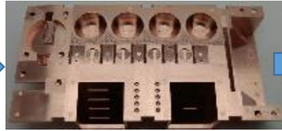
① 分子接合処理 → 無電解Cuめっき
