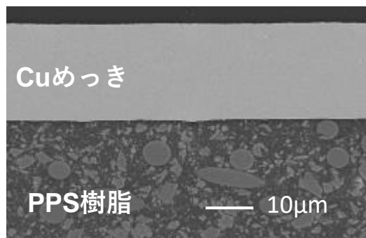
基材 : PPS樹脂 (射出成形)
