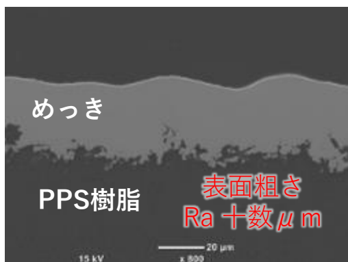
従来工法によるめっき断面
