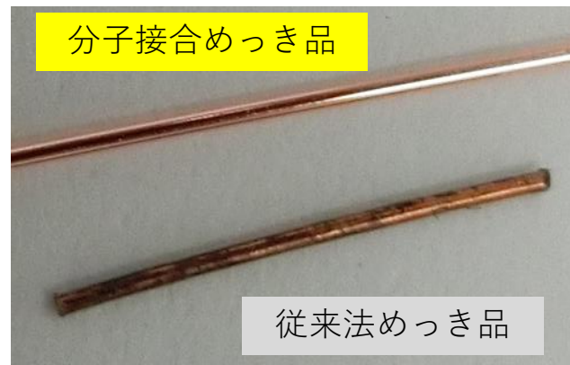
分子接合の配線形成 ポリイミドにダイレクト銅めっき
