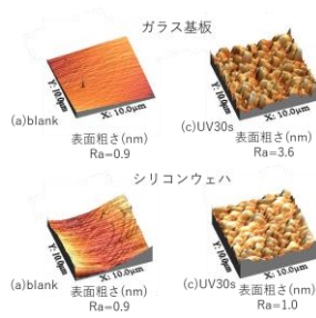
光反応性分子接合剤で処理したガラス、シリコンウェハのAFM像
